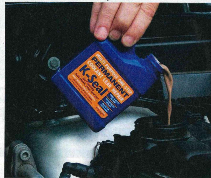
se déplacent de haut en bas dans le cylindre. Le produit est aspiré dans la fissure et est ensuite réparé lorsque les gaz chauds passent à travers la fissure.
